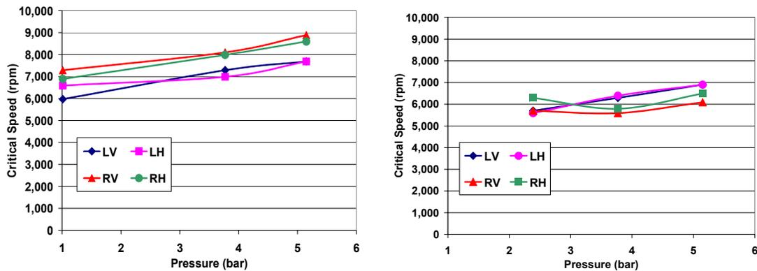
a) Bearing set #2, actual radial clearance 31.25 μm      b) Bearing set #1, actual radial clearance 39.45 μm
